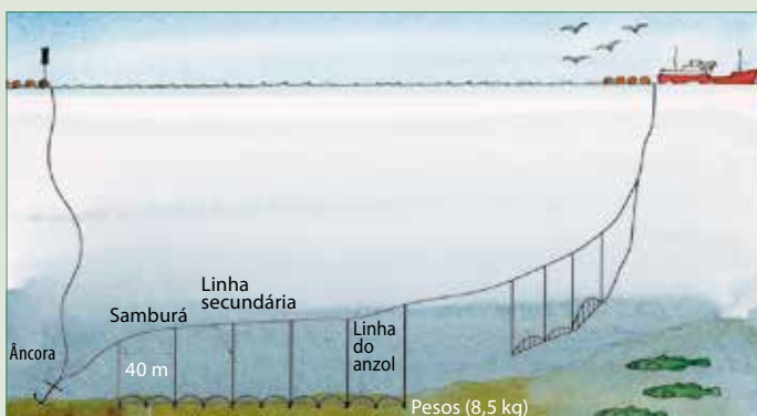
Figura 1. A configuração do espinhel de acordo com o Sistema Espanhol.
